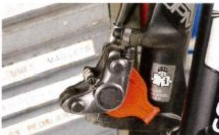
**2** - Avec une pince, retirez la goupille de sécurité fixée sur l'axe de maintien des plaquettes.
