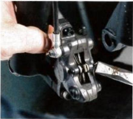
**3** - À l'aide d'un tournevis plat ou d'un clé BTR (cela dépend du modèle de freins), dévissez et retirez l'axe de maintien des plaquettes.
