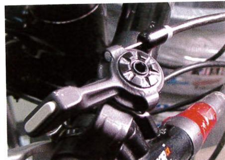
Certains VTT, comme ici le Cannondale Jekyll, sont dotés d'un levier au cintre qui permet d'ajuster le débattement de la suspension tout en roulant.
