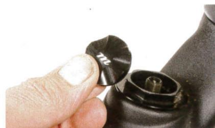
Le réglage de la précontrainte se fait via une valve Schrader, protégée des poussières et de la boue par un petit capuchon.
