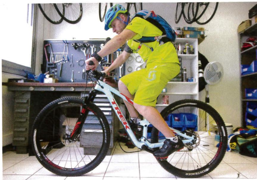
Le réglage de la précontrainte doit se faire assis sur le vélo, avec ses vêtements et chaussures de VTT, casque sur la tête et sac à dos rempli, comme si vous partiez rouler. Pour le réglage de la fourche, l'idéal est de se mettre debout sur les pédales ainsi le poids est réparti d'une façon plus homogène, et de se faire aider par un copain qui vous tiendra le vélo.
