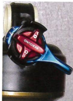
Les amortisseurs Fox haut de gamme sont dotés d'un levier qui permet de limiter l'effet de pompage en jouant sur la compression. Ce levier est parfois associé à une molette, à deux ou trois positions, qui permet de modifier le niveau de l'effet anti-pompage, lorsque le levier est actionné.
