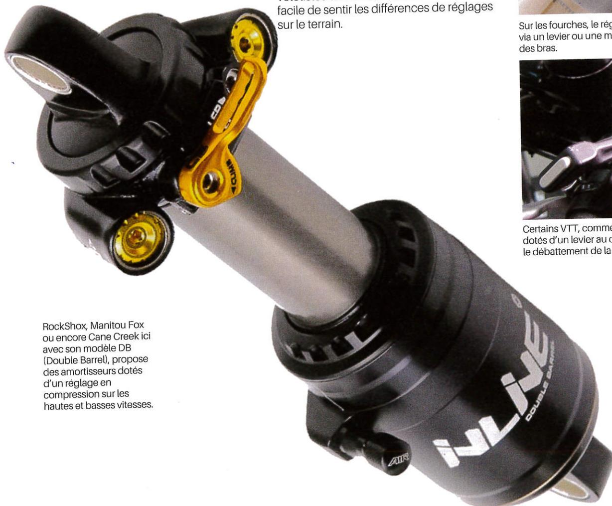
RockShox, Manitou Fox ou encore Cane Creek ici avec son modèle DB (Double Barrel), propose des amortisseurs dotés d'un réglage en compression sur les hautes et basses vitesses.
