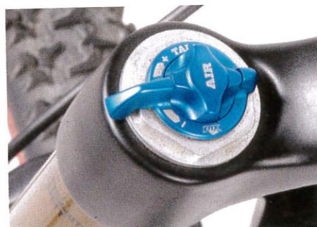
Sur les fourches, le réglage de débattement se fait via un levier ou une molette placé en haut de l'un des bras.
