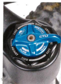
Sur les fourches, la molette ou le levier qui permet d'ajuster la compression est généralement de couleur bleue.
